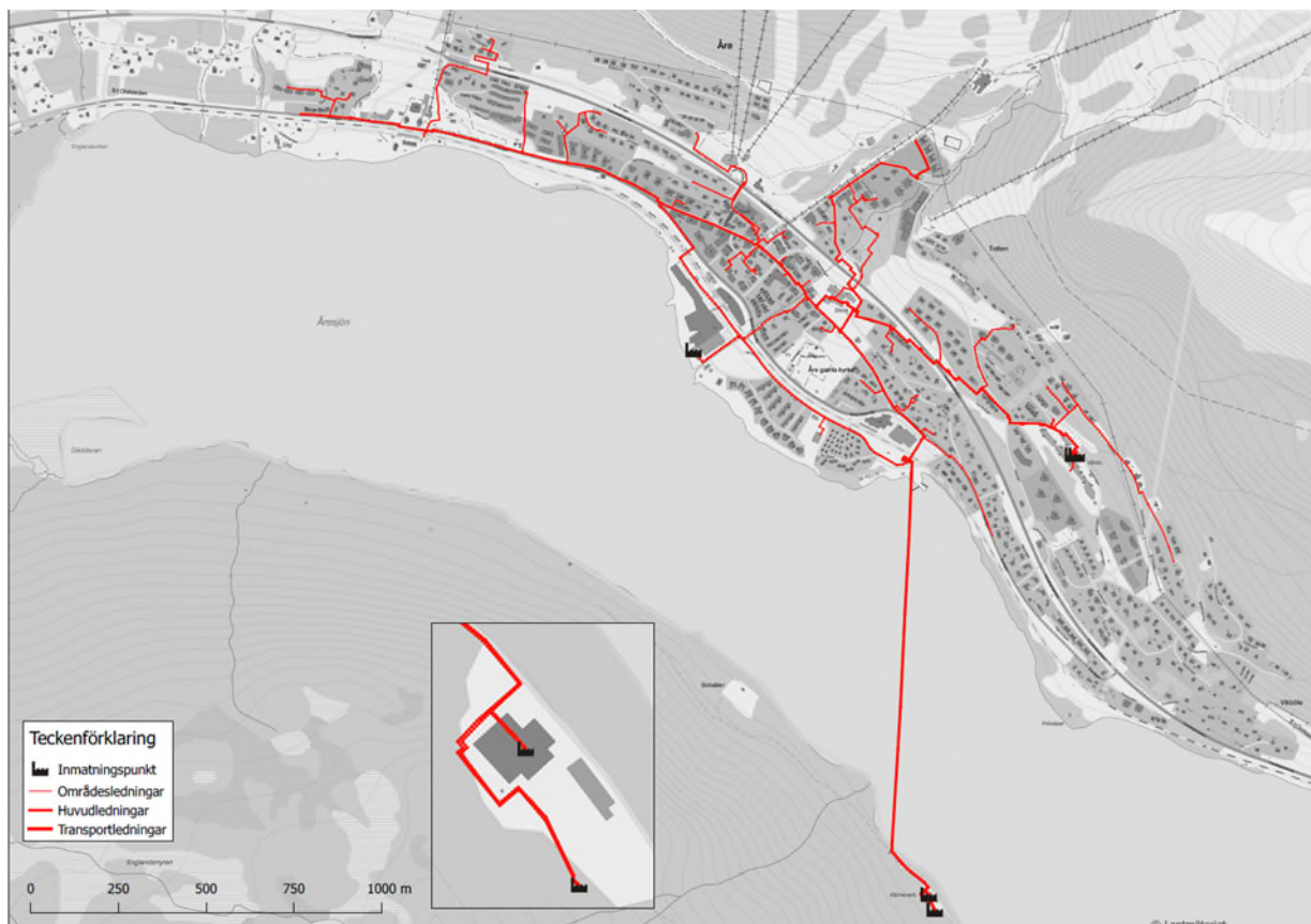
FIGUR 3 JÄMTKRAFTS FJÄRRVÄRMENÄT I ÅRE.
